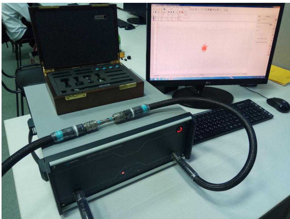
Рисунок 1.76 – Векторный анализатор цепей P4226 с комплектом калибровки
