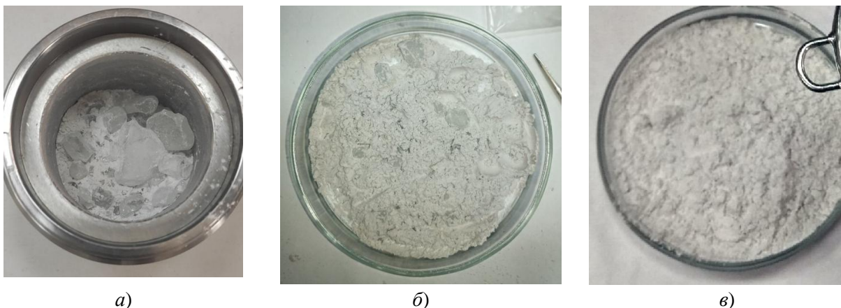
Рисунок 1.4 – Полученный порошок тугоплавкого стекла
