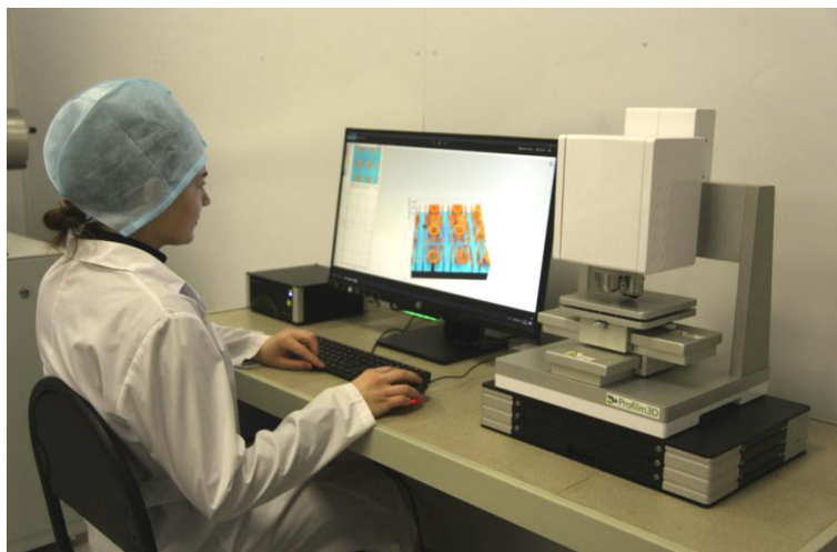
Рисунок 1.30 – Работа на профилометре Profilm3D
