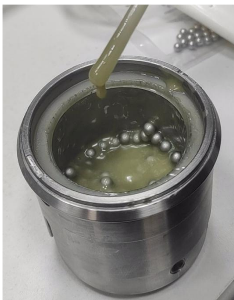
Рисунок 1.8 – Полученная паста на основе тугоплавкого стекла
