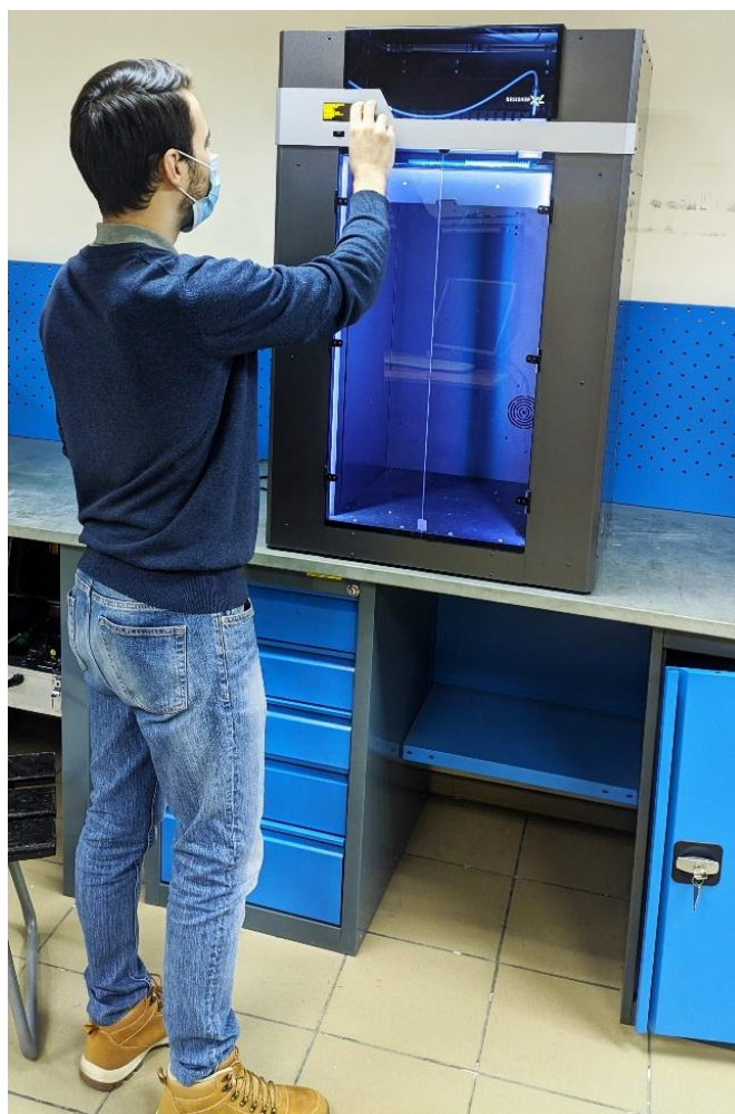
Рисунок 1.74 – Внешний вид 3D-принтера Picaso Designer XL в процессе печати в ЦКП «Импульс»
