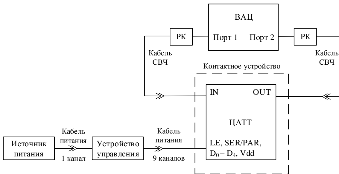
Рисунок 2.3 – Схема измерительной установки для измерения параметров рассеяния цифрового аттенюатора
