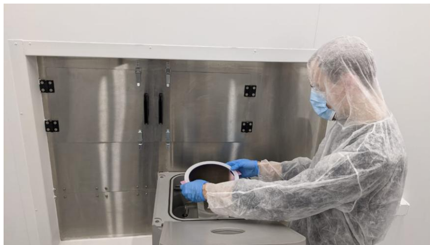
Рисунок 1.75 – Фотография загрузочного шлюза STE ICP 200D
