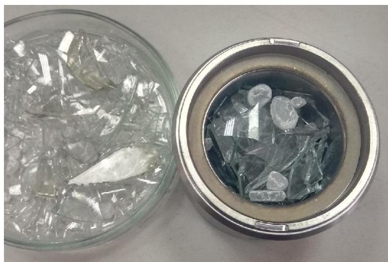
Рисунок 1.3 – Загрузка в размольный стакан тугоплавкое стекло
