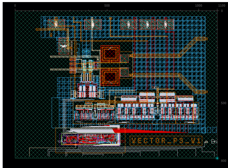
Рисунок 10.95 – Предполагаемая топология дифференциального векторного ФВ (1,1×0,8 мм 2 , без учета площадок)
