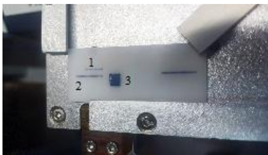
1– линия толщиной 0,4 мм; 2– линия толщиной 0,8 мм; 3 – прямоугольник
