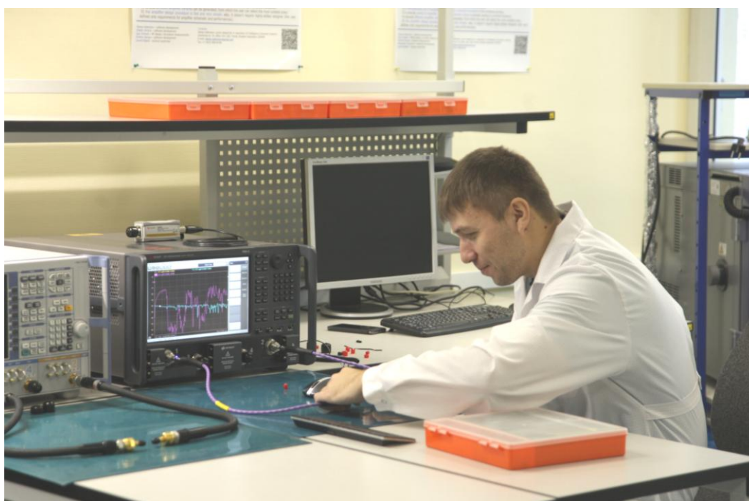
Рисунок 1.34 – Рабочее место с векторным анализатором цепей N5247B
