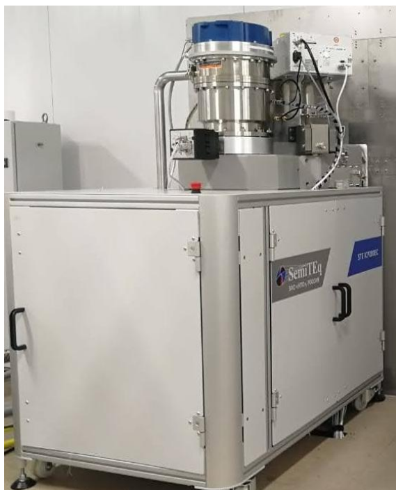
Рисунок 1.63 – Фотография установки ПХТ STE ICP200E
