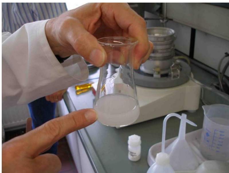
Рисунок 1.25 – Подготовка пробы с добавлением воды
