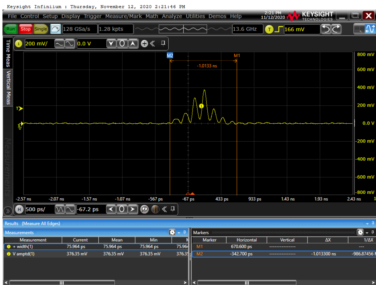
Рисунок 1.56 – Осциллограмма сигнала с выхода приемо-передатчика измерительного устройства
