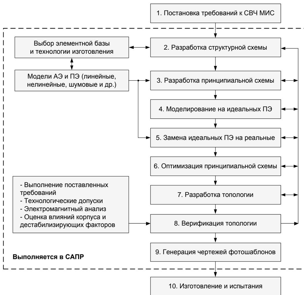
Рисунок 1.91 – Технология проектирования СВЧ МИС в САПР СВЧ устройств
