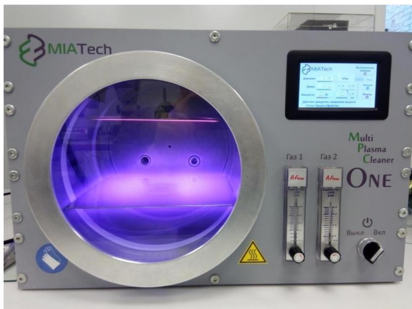
Рисунок 3.20– Установка плазменной очистки (дополнительное оборудование ЦКП)
