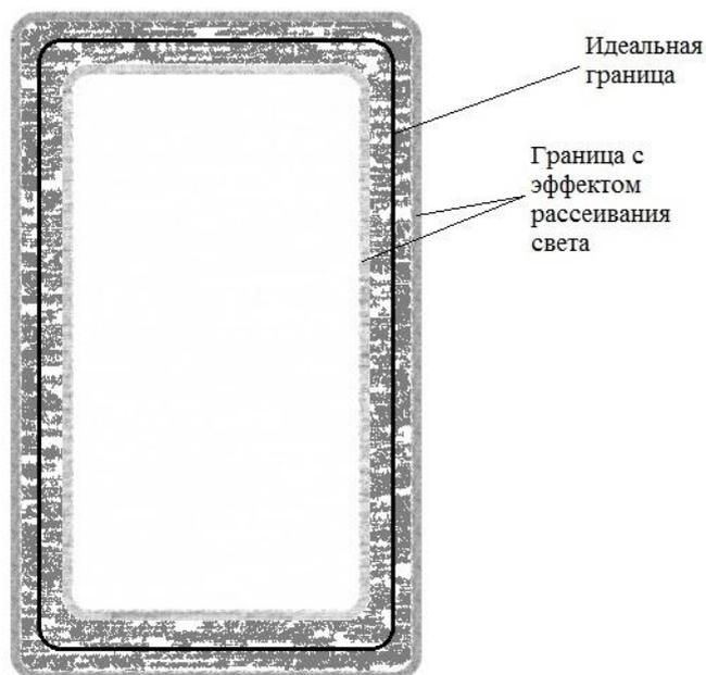
Рисунок 4.29 – Рисунок с границами элемента
