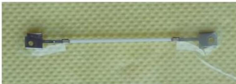
Рисунок 3.26 – Фотография керамической подложки с металлическими наконечниками по краям
