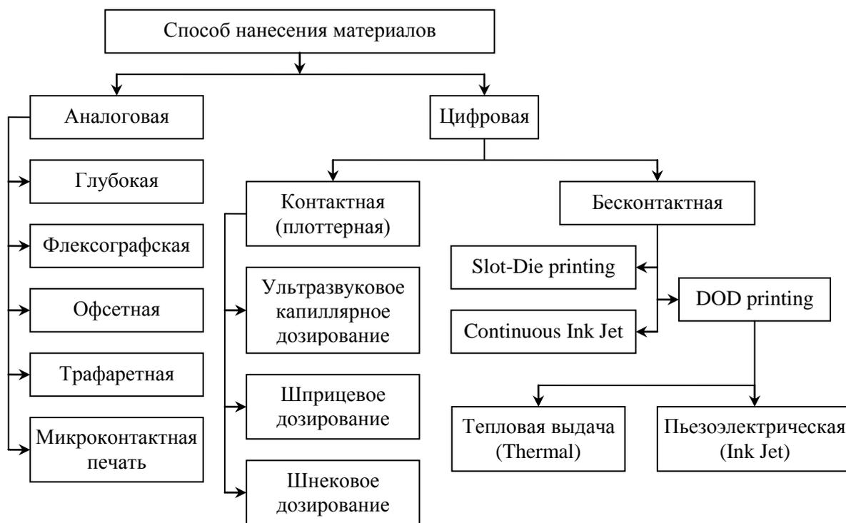
Рисунок 3.48 – Классификация технологии печати по способу нанесения материала
