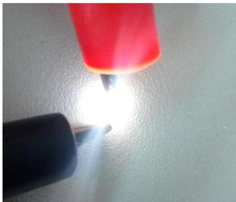
Рисунок 3.32 – Фотография светящегося кристалла, электрически соединенного с печатными проводниками приклеиванием
