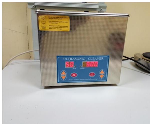
Рисунок 3.19 – Установка для промывки в ультразвуковой ванне (дополнительное оборудование УНУ)
