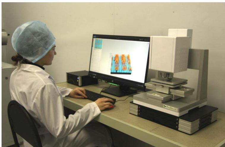
Рисунок 2.5 – Работа на профилометре Profilm3D
