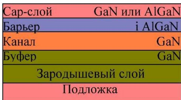
Рисунок 1.37 –Гетероструктура НЕМТ транзистора на базе AlGaN/GaN
